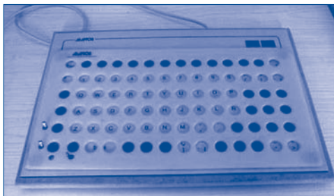
Teclado especial diseñado por el Centro junto con un alumno con parálisis cerebral de secundaria
